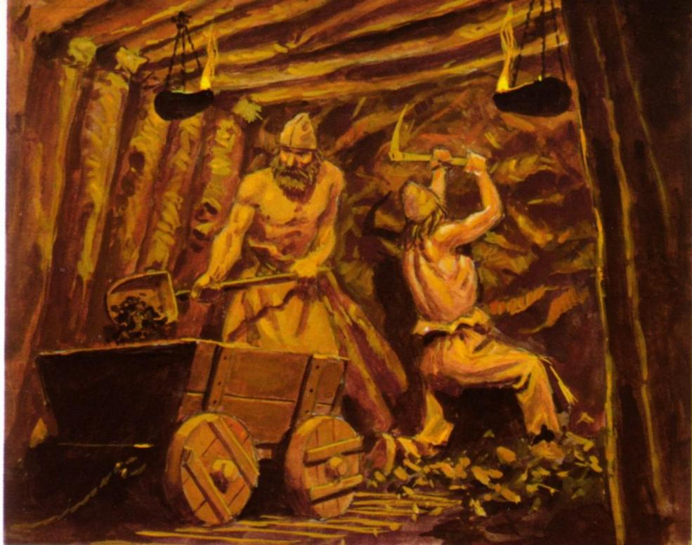
Solidement étayée par des rondins, la galerie de cette mine de fer est éclairée par des lampes en pierre remplies de graisse. Protégés par un bonnet et un tablier de cuir, mais torse nu car il fait chaud, les mineurs attaquent la roche au pic. Le minerai est chargé dans des chariots.
