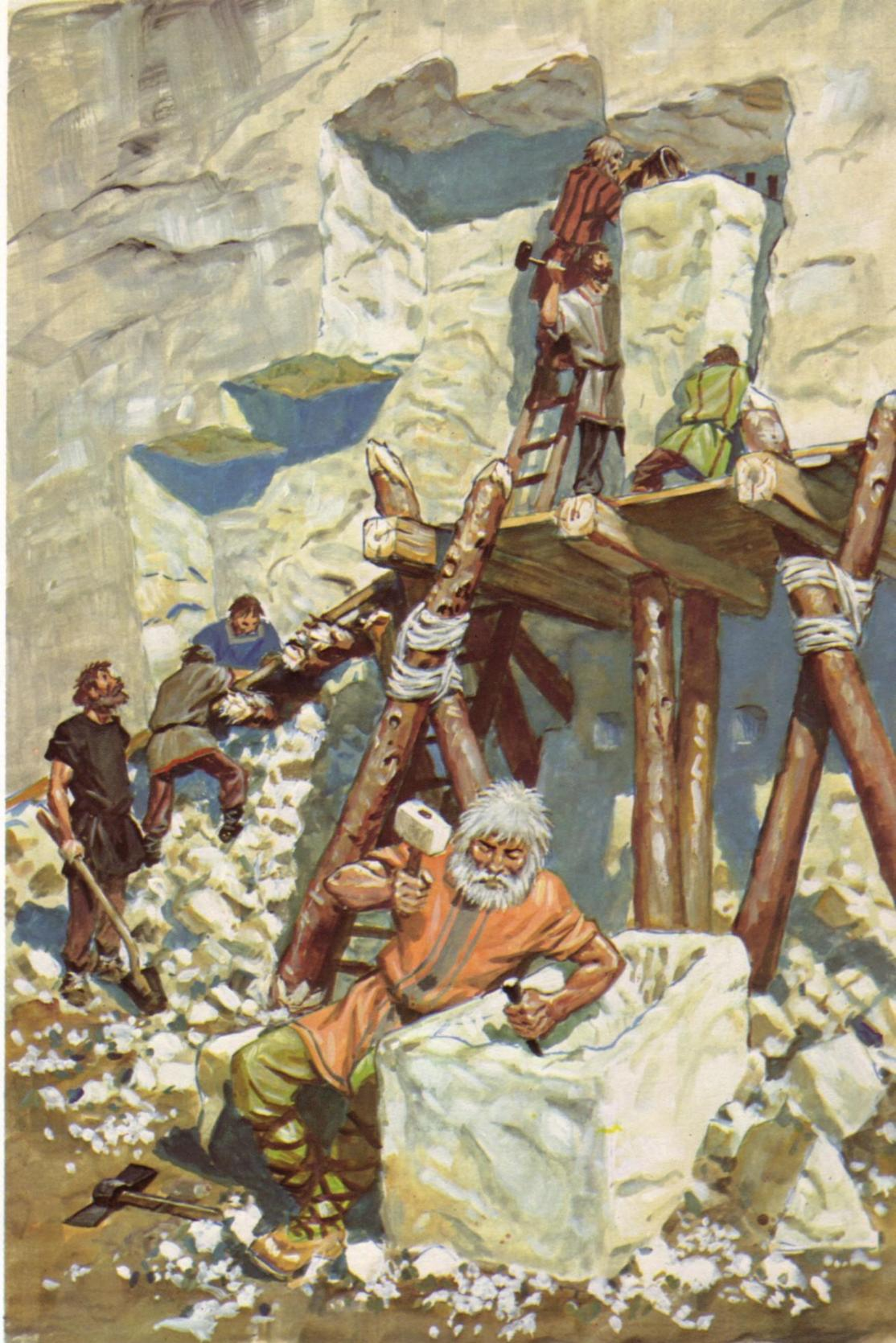
Montés sur un échafaudage, les carriers d'Arcy-sur-Cure délimitent au pic le bloc trapézoïdal de calcaire dans lequel on taillera la cuve du sarcophage. À l'aide de coins de bois, mouillés pour qu'ils gonflent, ils détachent la masse de pierre du front de la carrière. Un plan incliné permet de faire glisser le bloc jusqu'au sol, où on commence à l'évider.
