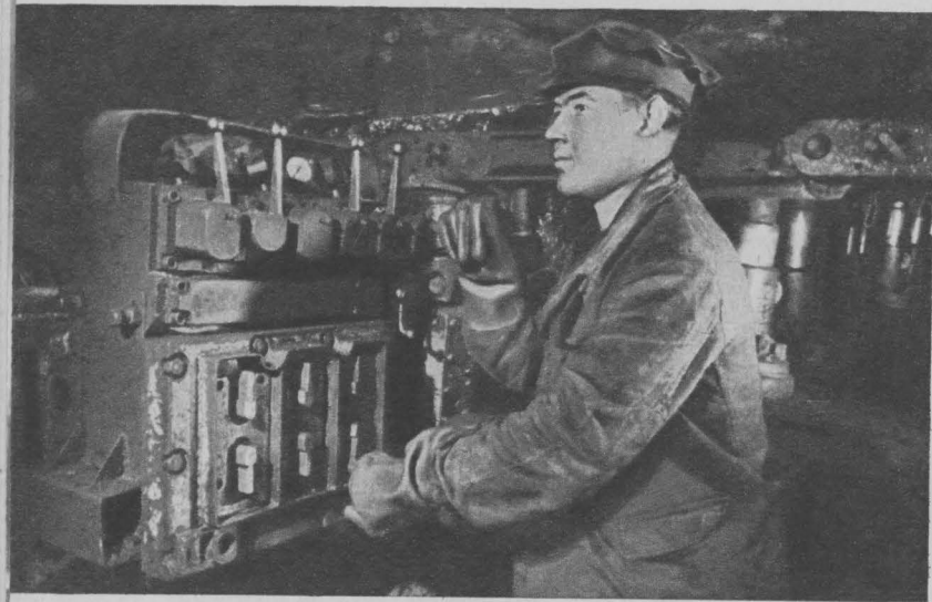
Больше двух лет работает на шахте Ново-Моспино Сталинской области угледобывающий агрегат А-2. Эта машина обеспечивает комплексную механизацию добычи угля, не требуя постоянного присутствия людей в забое. Агрегат управляется одним человеком.
