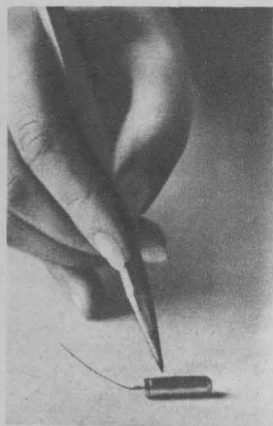
Этот миниатюрный прибор — газоразрядный счетчик — служит для ранней диагностики опухолей пищевода и желудка
