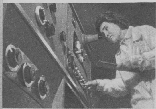
В аналитической ультрацентрифуге при скорости вращения 60000 оборотов в минуту проверяется чистота вновь полученного фермента. Диаграммы свидетельствуют о высокой степени чистоты фермента. Теперь можно исследовать его строение и свойства
