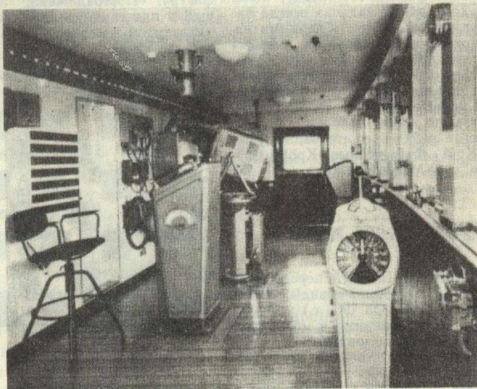
В рулевой рубке чисто и, если судно не на ходу, — тихо. Стрелки машинного телеграфа стоят на «Стоп», реиптер гирокомпаса на нуле, указатель положения руля тоже переведен на ноль. Тут мозг корабля, управлять отсюда почетно.
