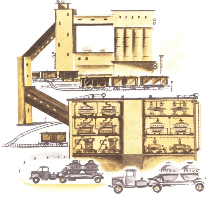
Перед тобой — мельница. Видишь: справа вверху цилиндры, возле которых стоят вагоны. Это элеватор. На самом деле, цилиндры железобетонные, огромные — с семиэтажный дом, а в вагонах к ним привозят зерно.
