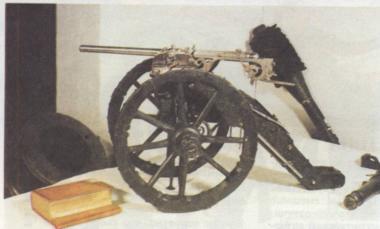
1-фунтовая Саксонская опытная пушка конструкции Гойера. Конец XVII века. (1/5 натуральной величины). Массивный лафет с боковыми упорами обеспечивал устойчивость орудия при стрельбе на различных углах горизонтальной наводки.
