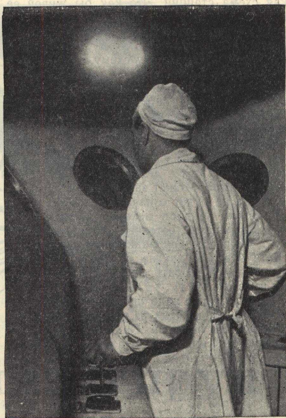
За разгрузкой реактора наблюдают через защитные стёкла в толстой чугунной стене.
