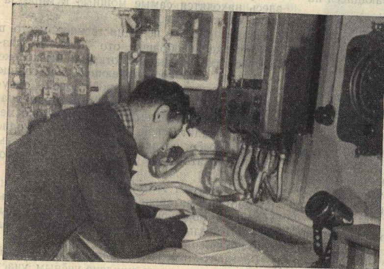
Во время всего пути «Оби» учёные изучали рельеф морского дна. Научный сотрудник А. Ф. Береснев в лаборатории геологии моря работает с эхолотом — прибором для измерения глубины моря.
