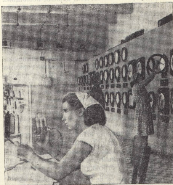
Отсюда, из комнаты контрольно-измерительных аппаратов, молодые химики управляют печами, компрессорами, холодильными установками, по приборам следят за длинной цепью превращений газов в каучук
