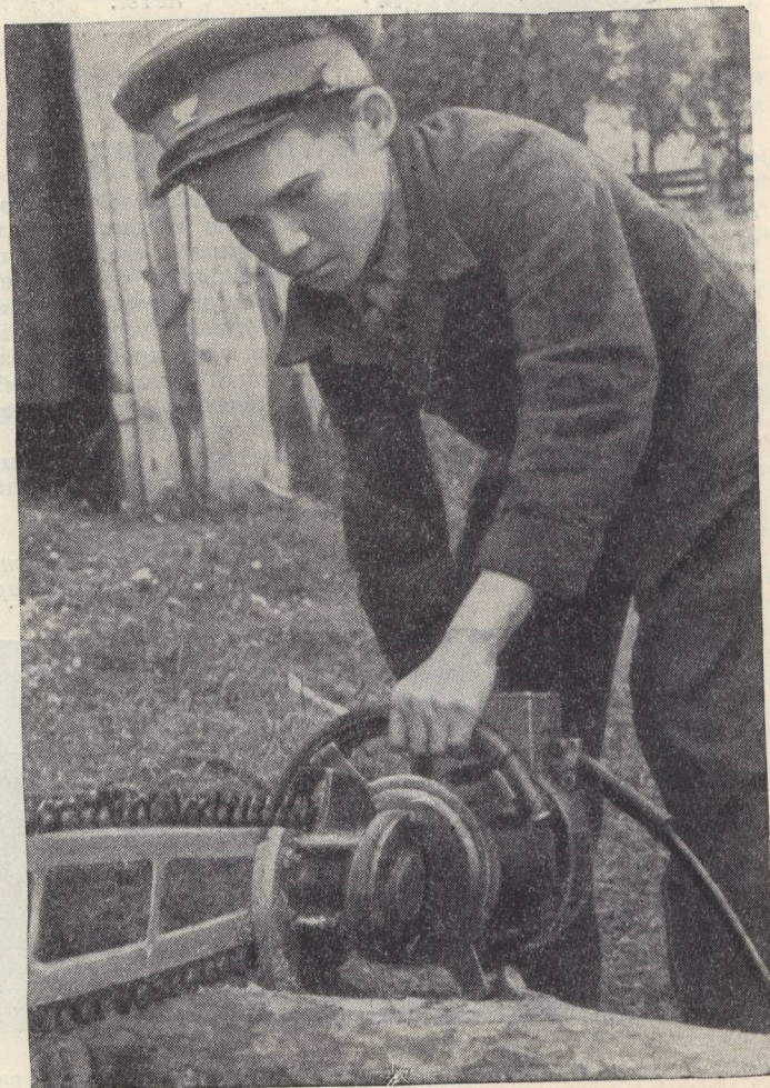
Вот что значит техника! Электрической пилой Саша Александров может за час распилить больше двух кубометров дров.
