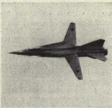
Многоцелевой истребитель с изменяющейся в полете стреловидностью крыла. На верхнем снимке — самолет идет на большой скорости, крылья подтянуты к хвостовому оперению. Внизу — так выпрямляются крылья, когда скорость невелика и когда машина идет на взлет и посадку.
