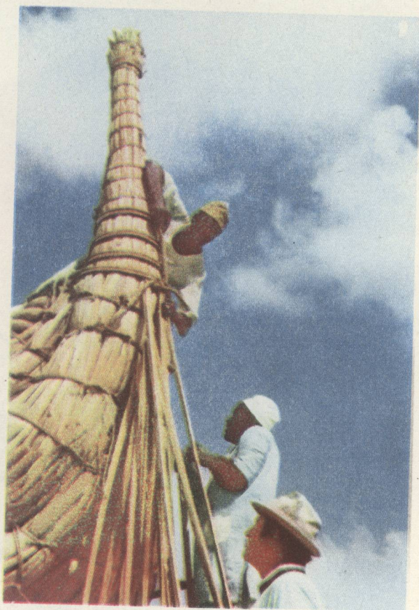
Негры племени батума заканчивают отделку носа ладьи. Внизу — Тур Хейердал. Хорошо видны стебли папируса, похожие на знакомые нам стебли камыша.
