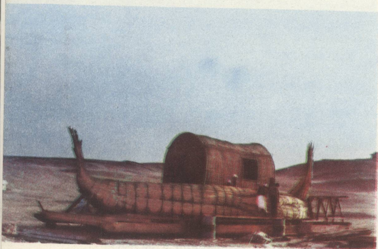
Ладья «Ра» построена. Уже после того как ее спустят на воду в порту Сафи, на ней появятся мачта и парус.
