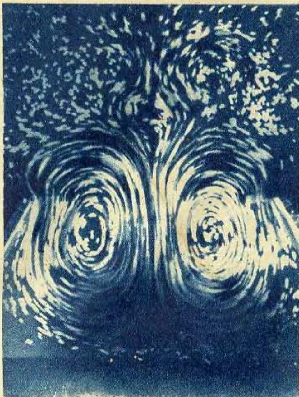
Удачным подбором направляющих стенок водосброса была устранена опасность проникновения воздуха в трубы. На этом снимке вы уже не заметите воронки.
