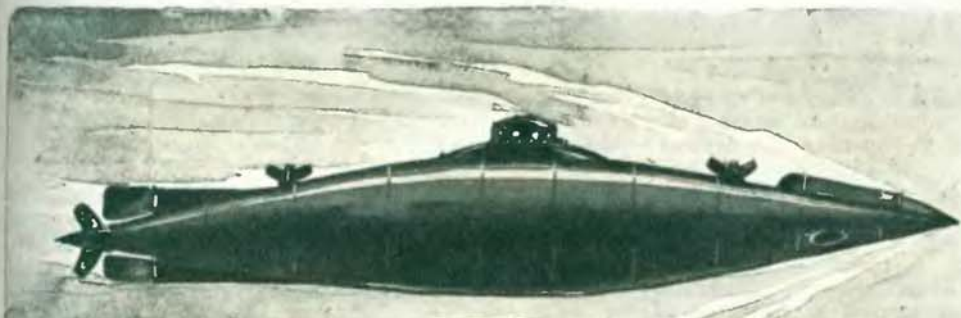
Первая дизельная подводная лодка «Минога» была построена в России в 1908 г. В отличие от прежних лодок веретенообразной формы, она имеет более совершенную, обтекаемую форму рыбы. Лодка снабжена двумя гребными винтами, которые под водой приводятся в действие электромоторами.
