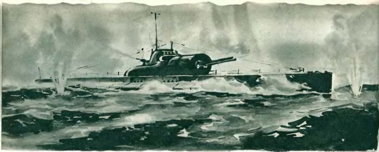
Современный французский подводный крейсер «Сюркуф». Эта гигантская подводная лодка имеет 4 пушки, 4 пулемета и 14 торпедных аппаратов. Диаметр ее торпеды — более полу-метра. Мощность механизмов «Сюркуфа» — 7600 лошадиных сил.
