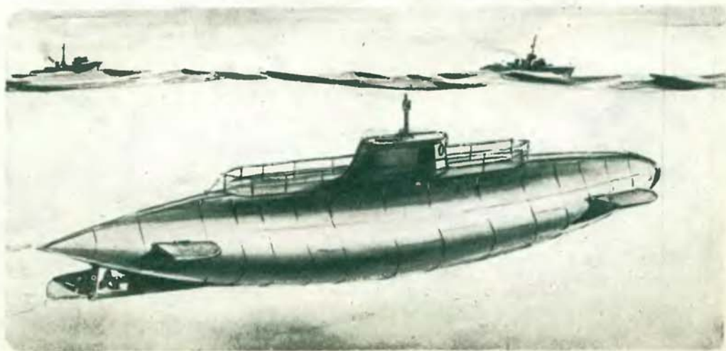
Большая лодка русского изобретателя Александровского имела 30 метров длины и 4 метра ширины. Она двигалась под водой с помощью сжатого воздуха. Лодка была снабжена горизонтальными рулями глубины.
