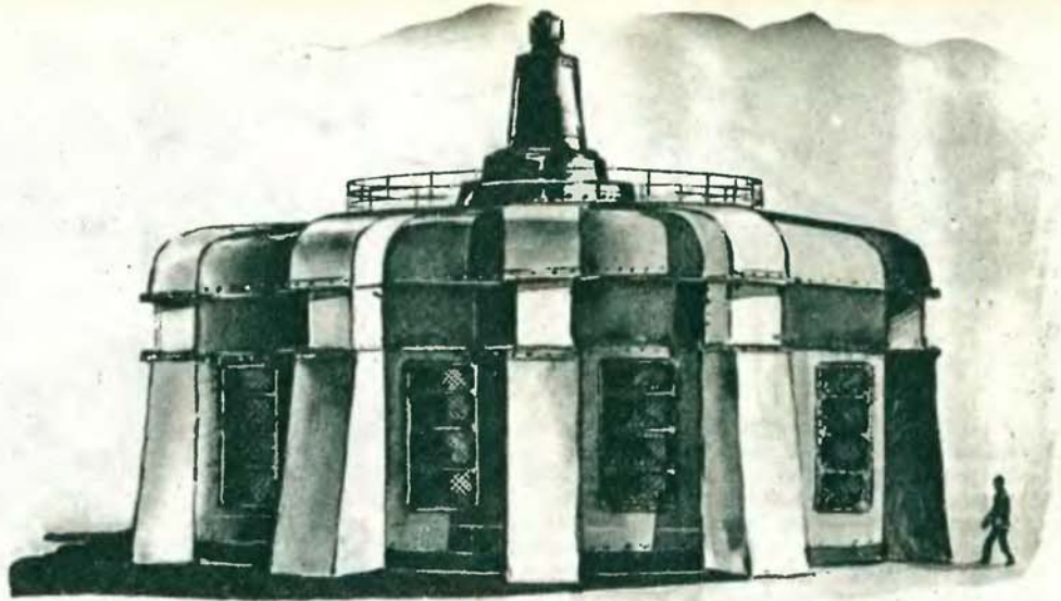
Почти на 6,5 метра возвышается этот генератор над полом машинного зала и на 12 метров уходит в нижние этажи. Вал машины углубляется в толщу плотины еще на 30 метров. На конце его насажено рабочее колесо турбины.
