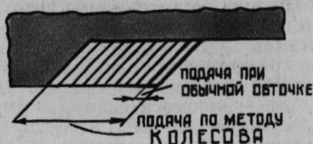
Поддачи при работе резцом Колесова в 8–12 раз превышают поддачи при скоростном резании.
