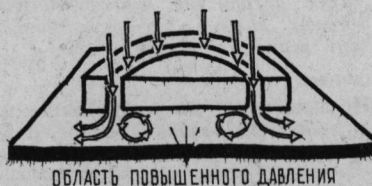
Разрез кольцевого сопла. Вытекающий сквозь щели воздух создает внутри воздушного цилиндра зону повышенного давления.
