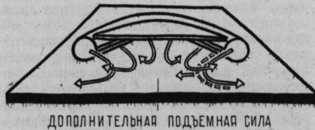
Разрез кольцевого сопла, из которого струя воздуха вытекает внутрь воздушного цилиндра под некоторым углом, так, как если бы на ее пути стояли изогнутые турбинные лопатки (пунктирная линия). Благодаря этому создается дополнительная подъемная сила.
