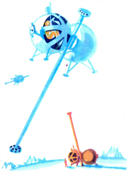
Проект лунного «кузнечика»: две кабины, способные перемещаться вдоль штанги под действием сжатого газа.
