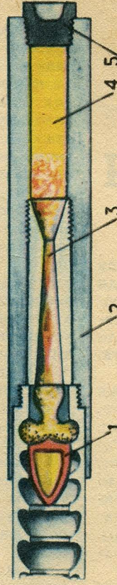
207. Схема ствола турбопушки Делама-Маз. Цифрами обозначены: 1 — снаряд, 2 — ствол, 3 — сопло, 4 — камера, 5 — затвор.
