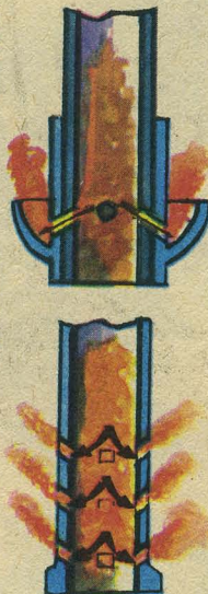
Г. Устройство дульного тормоза системы Дурляхова.
