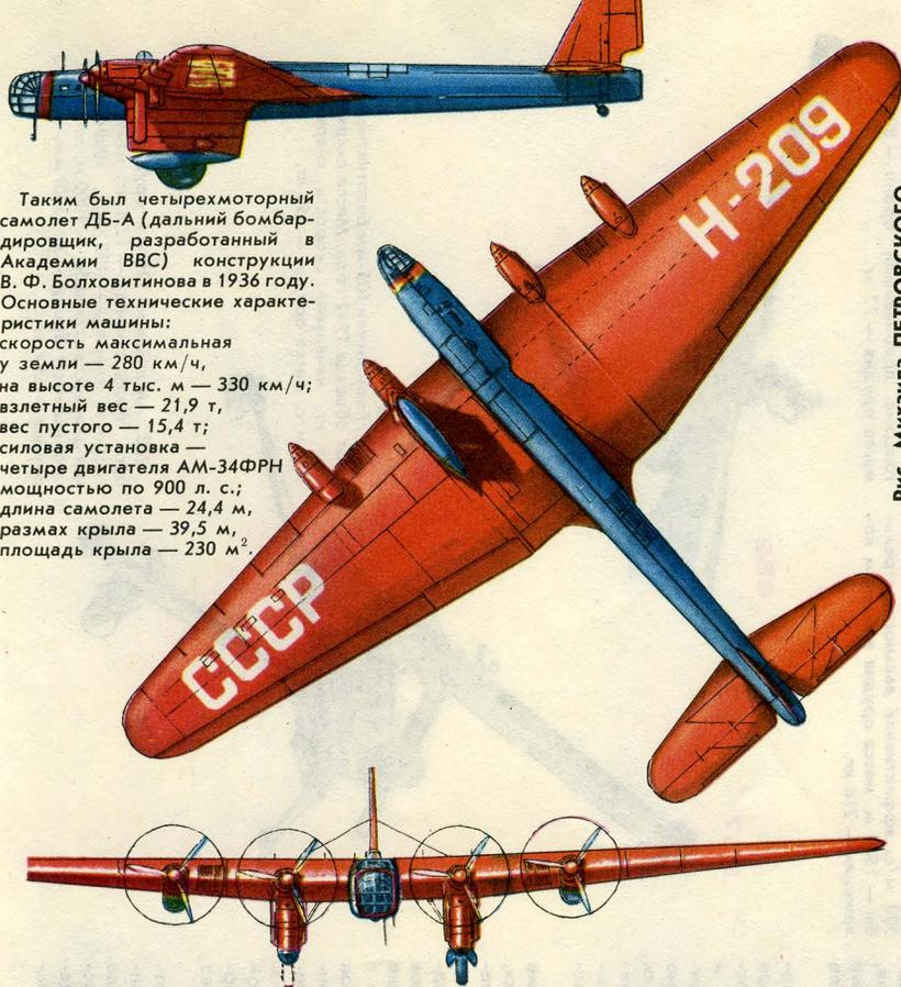
Таким был четырехмоторный самолет ДБ-А (дальний бомбардировщик, разработанный в Академии ВВС) конструкции В. Ф. Болховитинова в 1936 году. Основные технические характеристики машины: скорость максимальная у земли — 280 км/ч, на высоте 4 тыс. м — 330 км/ч; взлетный вес — 21,9 т, вес пустого — 15,4 т; силовая установка — четыре двигателя АМ-34ФРН мощностью по 900 л. с.; длина самолета — 24,4 м, размах крыла — 39,5 м, площадь крыла — 230 м<sup>2</sup>.
