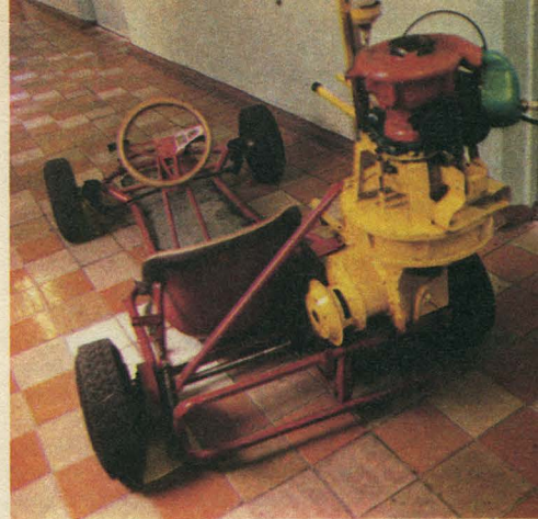
Так выглядит экспериментальный автомобильчик с гибридным приводом.
