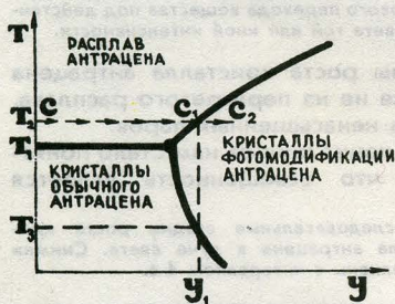
Рис. 4. Фазовая диаграмма антрацена в координатах температура — интенсивность падающего на вещество света.
