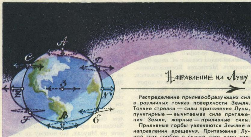
Распределение приливообразующих сил в различных точках поверхности Земли. Тонкие стрелки — силы притяжения Луны, пунктирные — вычитаемая сила притяжения Земли, жирные — приливные силы. Приливные горбы увлекаются Землей в направлении вращения. Притяжение Луной этих горбов в сумме дает пару сил, тормозящую вращение планеты.
