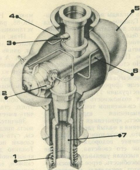
Агрегаты криогенного топливопровода. Цифрами обозначены: 1. Тепловой мост (изолятор). 2. Вакуум  $10^{-4}$  мм рт. ст. 3. Клапан перекрытой. Его внутренняя поверхность — зеркальная. 4. Кожух. Внутренняя поверхность — зеркальная. 5. Спешиметр (осуществляет контроль состояния криогенного топлива — количество паровой фазы). Внешняя поверхность — зеркальная.
