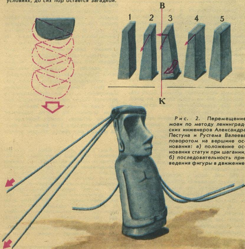
Рис. 2. Перемещение моаи по методу ленинградских инженеров Александра Пестуна и Руслема Валева поворотом на вершине основания: а) положение основания статуи при шагании; б) последовательность приведения фигуры в движение.
