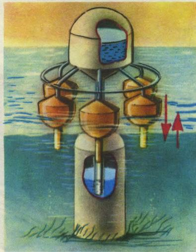
лонной стенки давление резко повышается. Открыв клапаны одностороннего действия, вода устремляется в полость модуля и сжимает находящийся там воздух. При откате волны воздушное давление закрывает клапаны и выталкивает воду через патрубок в нижний бассейн. При сильном волнении напор воздуха будет так велик, что позволит закачивать воду через трубопровод также и в верхний аккумулирующий бассейн.
