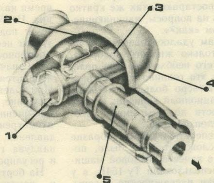
Заправочный узел. Цифрами обозначены: 1. Компенсатор (гофрированная трубка, предохраняющая от тепловых деформаций). 2. Тепловой мост. 3. Датчик температуры. 4. Вакуум  $10^{-4}$  мм рт. ст. 5. Кожух. Внутренняя поверхность — зеркальная. 6. Клапан перекрытой. 7. Посадочное место под штыковой разъем.
