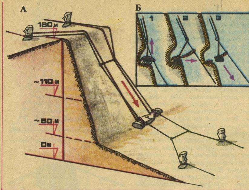
Рис. 6. Предполагаемая схема спуска истуканов с каменоломен на юго-западном склоне вулкана Ранго-Параку (А) и последовательность подвешивания моаи к «канатной дороге» (Б).
