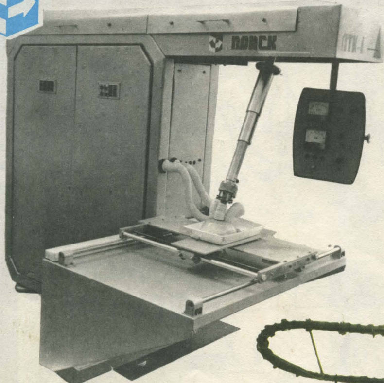
Лазерная установка микролегирования в жидких средах.
