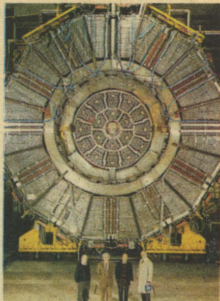
Пучки электронов и позитронов, бежущие навстречу друг другу по кольцу LEP, синхронизированы так, что сталкиваются в четырех точках тоннеля. Здесь вырублены подземные залы, где размещаются сложнейшие многотонные детекторы частиц.
