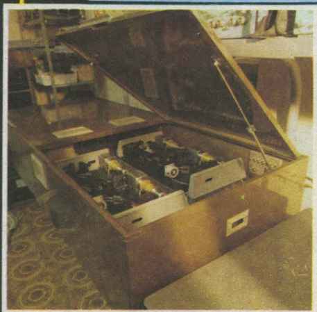
КАРС — спектрометр, созданный в виде прибора, достаточно компактен. Одна из его крышек приподнята, внутри видны лазеры.
