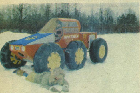
Пневмоход КСТТ Пермского объединения «Моторостроитель» выполнен по традиционной схеме на базе мотоцикла «Иж-Юпитер-5». Габариты — 1800×4000×2500 мм, снаряженная масса — 300 кг, дорожный просвет — 50 см, максимальная скорость — 80 км/ч. Авторы — Ю. Вагин, М. Зиннатуллин и В. Тарасов. Это универсальное скоростное транспортное средство для любого времени года.
