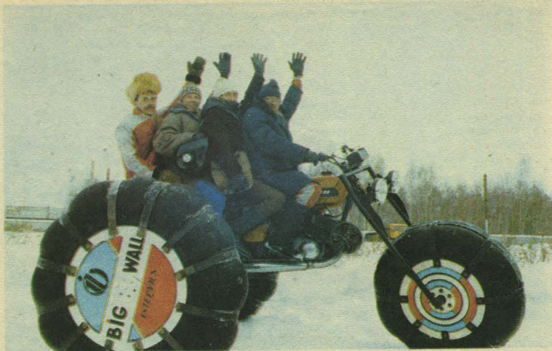
Пневмоход КСТТ Пермского объединения «Моторостроитель» выполнен по традиционной схеме на базе мотоцикла «Иж-Юпитер-5». Габариты — 1800×4000×2500 мм, снаряженная масса — 300 кг, дорожный просвет — 50 см, максимальная скорость — 80 км/ч. Авторы — Ю. Вагин, М. Зиннатуллин и В. Тарасов. Это универсальное скоростное транспортное средство для любого времени года.
