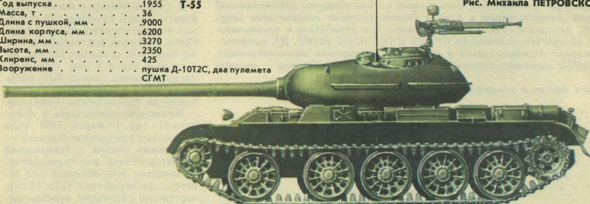
Бронирование, мм . . . . . лоб корпуса — 100, борт — 80, корма — 45, лоб башни — 200, крыша — 15, днище — 20
