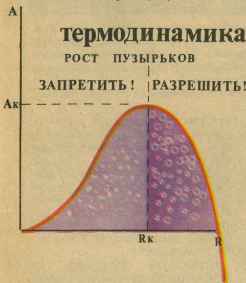
Рис. 4. Зависимость работы образования пузырька пара в перегретой жидкости от его радиуса; A_k и R_k — работа образования и радиус способного к росту пузырька.
