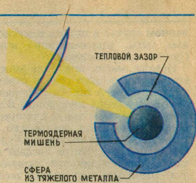
Рис. 6. Лазерная мишень в тяжелой металлической оболочке для использования эффекта самосжатия плазмы за счет спонтанных магнитных полей.
