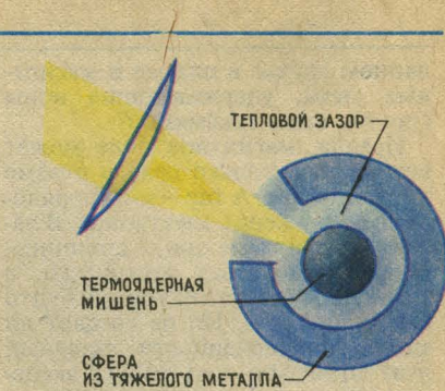
Рис. 6. Лазерная мишень в тяжелой металлической оболочке для использования эффекта самосжатия плазмы за счет спонтанных магнитных полей.
