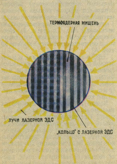
Рис. 5. Лазерная мишень с нанесенными кольцевыми проводящими дорожками для гибридного варианта термоядерного синтеза.
