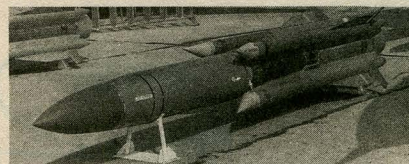
Х-31П: стартовая масса — 600 кг, масса боевой части — 90 кг, длина — 5,2 м, диаметр корпуса — 0,36 м, дальность полета — 100 км.
