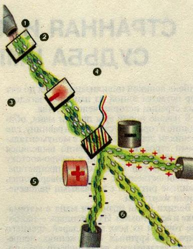
Рис. 3. Так разделяют мужские и женские спермии быка: 1. сперма впрыскивается в аппарат; 2. окрашивается флуоресцентным красителем; 3. освещается лазером; спермии с X-хромосомой флуоресцируют ярче, чем с Y-хромосомой; 4. электрическое поле заряжает мужские спермии положительно, женские — отрицательно; 5. электроды высокого напряжения сепарируют спермии с различным электрическим зарядом; 6. незаряженные спермии (пол неясен) отвергаются.
