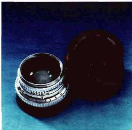
◀ Между этими двумя объективами — сорок лет развития. Старый объектив без антиотражательного (антибликового) покрытия. Окружающее освещение отражается в линзах, и они кажутся белесыми. Современный «просветленный» объектив имеет лишь слабые блики
