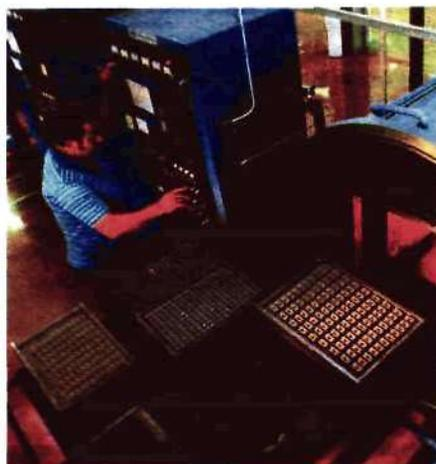
*Печь для нанесения защитного слоя путем конденсации. Регулируя температуру, давление и электрическое напряжение, можно достичь оптимального значения толщины и структуры слоя*
