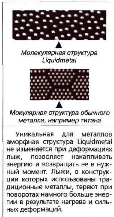
Уникальная для металлов аморфная структура Liquidmetal не изменяется при деформациях лыж, позволяет накапливать энергию и возвращать ее в нужный момент. Лыжи, в конструкции которых использованы традиционные металлы, теряют при поворотах намного больше энергии в результате нагрева и сильных деформаций.
