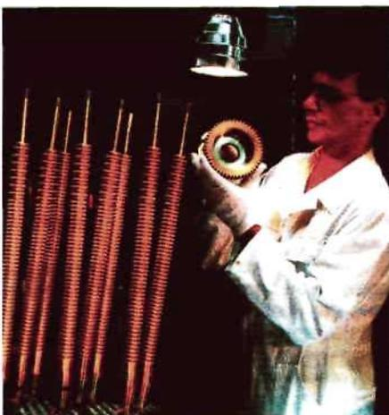
*Это покрытие золотого цвета сводит к минимуму износ и трение, поэтому части зубчатых колес коробки передач работают значительно дольше*
