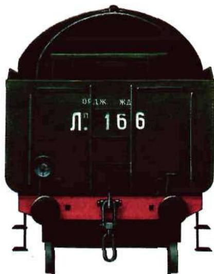
Тендер сзади — хорошо виден полукруглый нефтяной бак
