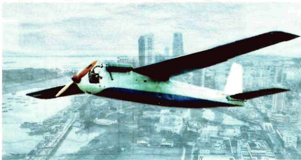
БПЛА «Иркут-20»: взлетный вес — 20 кг, размах крыла — 3 м, длина — 2,3 м, высота — 0,6 м, крейсерская скорость — 120 км/ч, наибольшая — 180 км/ч, длина взлетно-посадочной площадки — 150 м
