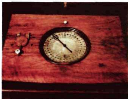
Стрелочный телеграфный аппарат с электромагнитным приводом. 1845 г.
