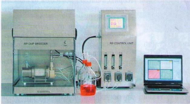
**Рис. 2.** Один из современных биореакторов – замкнутая и хорошо изолированная система жизнеобеспечения клеток, контролируемая электроникой, в которой происходит выращивание клеточного материала
