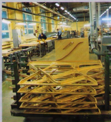
Чугунные рамы приходят чёрные, неприглядные на вид. На «Лире» есть цех, где их обрабатывают и наносят покрытие под бронзу
