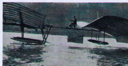
«Аэродром» Сэмюэла Лэнгли — аэроплан с тандемным крылом
