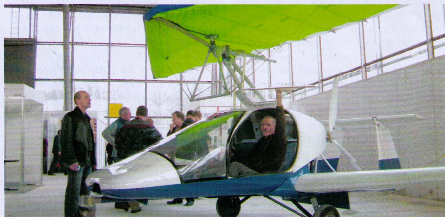
Герметичная кабина и манёвренность дельтаплана. Ещё один гибрид: дельта-самолёт Саита Ситдикова
