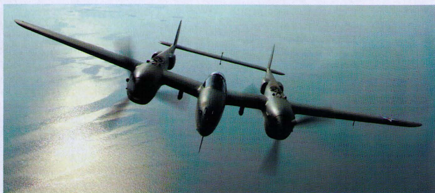
Р-38 «Лайтнинг» — ЛА двухфузеляжной схемы.
