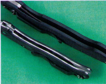
Огромная механическая прочность углепластика с успехом позволяет изготовить из него рукоять складного ножа вообще без металлической несущей рамки (сверху, Military). Рукоять ножа Stretch оборудована стальной несущей рамкой исключительно для того, чтобы развеять возможные сомнения в свойствах современных материалов. Да и то её сильно повырезали для уменьшения веса.
