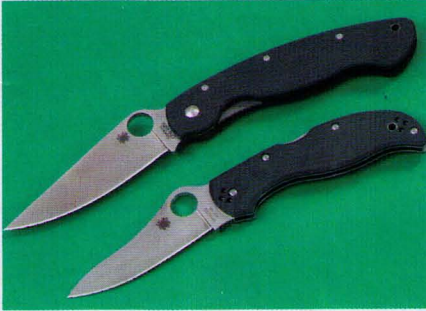
Ножи американской фирмы SPYDERCO с клинками из «сверхсталией». Сверху Military с клинком из американской CPM S90V, внизу Stretch с клинком из японской ZDP-189. Плашки рукоятей обоих ножей изготовлены из иного «космического» материала – углепластика.
