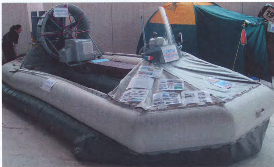
Воздушная подушка позволяет вездеходу «Шмель» передвигаться где угодно или нужно
