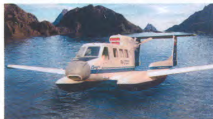
Многоцелевой грузопассажирский самолёт «Динго» с шасси на воздушной подушке
