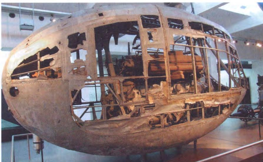
Бортовая гондола LZ 127 «Граф Цеппелин» с двигателем
