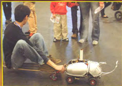
Корейский изобретатель роботов (танков, тракторов, грузовиков, паровозов) с паровыми двигателями И-Вей Хуан всегда поражал коллег по цеху оригинальностью разработок. Прообразом очередного его вездехода послужил жук-носорог. Робота приводит в движение четырёхцилиндровый паровой двигатель, который, вместе с резервуаром для воды, газовым баллоном с пропан-бутановой смесью для подогрева воды, размещён в алюминиевом корпусе.
