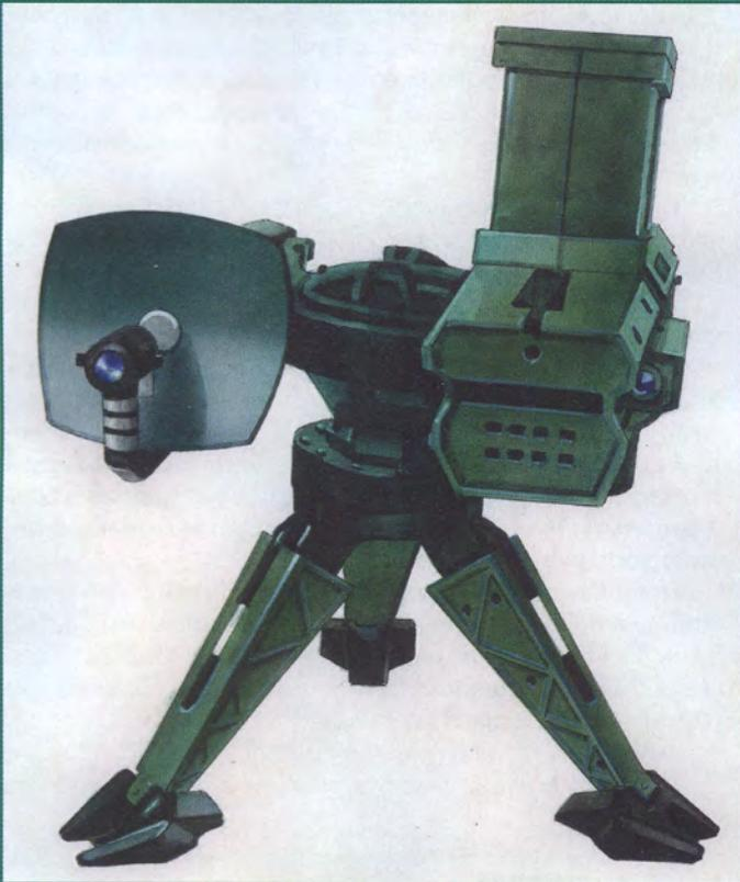
▲ Автоматический модуль с радиолокационным прицелом и пулемётной установкой. США
