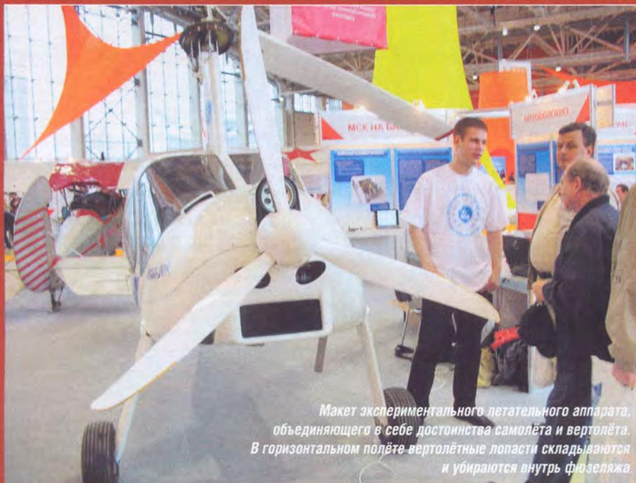
Макет экспериментального летательного аппарата, объединяющего в себе достоинства самолёта и вертолёта. В горизонтальном полёте вертолётные лопасти складываются и убираются внутрь фюзеляжа
