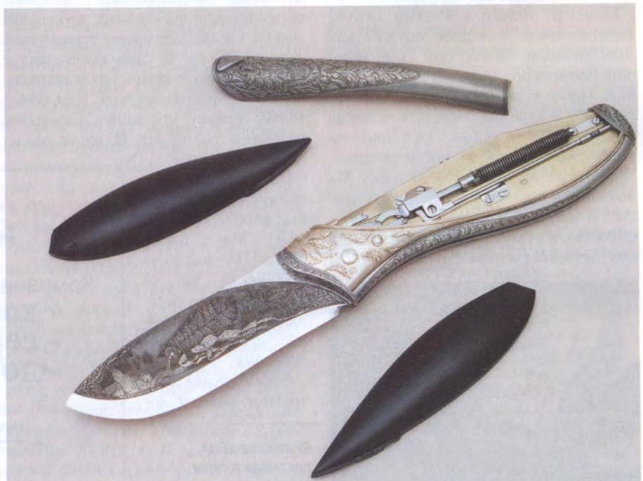
*«Блоха со снятой спинкой и деревянными щёчками. Хорошо виден механизм раскладывания»*
