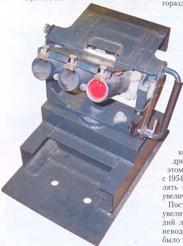
шнура производится выстрел. После выстрела гильза извлекается специальным экстрактором. Установка укомплектована простым открытым прицелом. Масса устройства 12 кг, а габаритные размеры — 330x400x235 мм. Оно позволяет выстреливать ракеты на дальность от 1,5 до 120 м.
