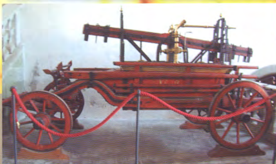
Пожарная повозка с насосом, приводимым в действие качанием коромысла
