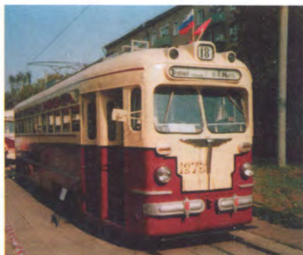
Вагон МТВ-82 – послевоенное развитие конструкции КМ
