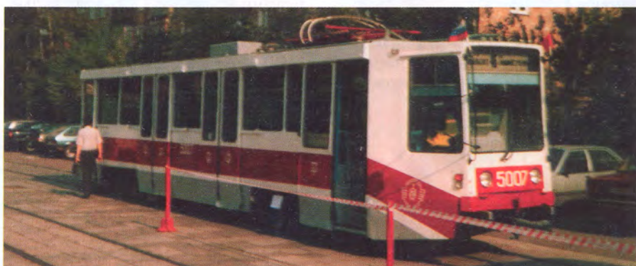
Вагон 71-608 Усть-Катавского вагоностроительного завода с отечественным блоком тиристорно-импульсного управления (в ящике над второй дверью), 1989 г., всего выпущено несколько штук
