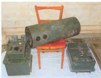
(8) Блоки питания, обеспечивающие применение шестикамерного ЭОПа для астрономических наблюдений. На стуле лежит фокусирующая катушка, слева – высоковольтный блок питания, справа – источник тока
