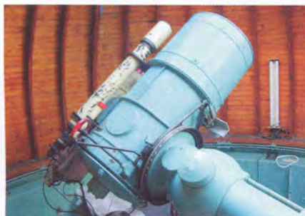
(7) Менисковый телескоп МТМ-500, имеющий диаметр главного зеркала 500 мм
