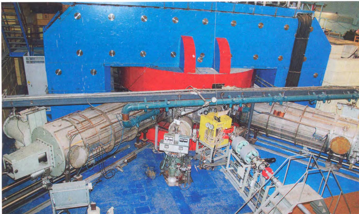
**Циклотрон У400М, входящий в DRIBs.**
