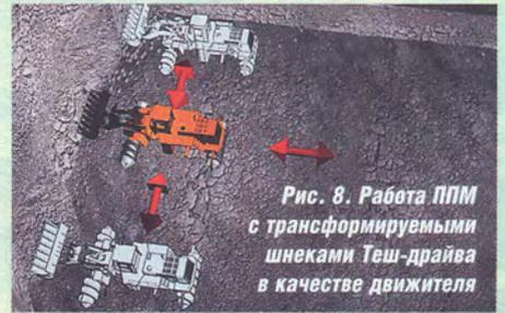
**Рис. 8. Работа ППМ с трансформируемыми шнеками Теш-драйва в качестве движителя**
