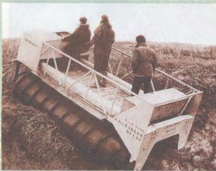
**Рис. 1.** Шнекоход — это вездеход, движение которого осуществляется посредством шнекороторного двигателя.
