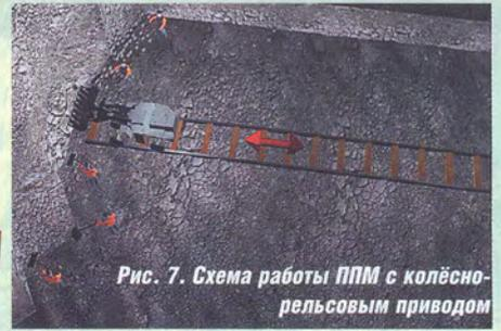
**Рис. 7. Схема работы ППМ с колёсно-рельсовым приводом**
