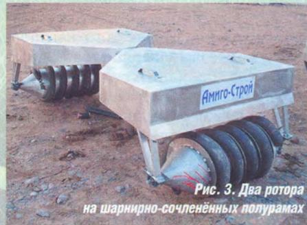
**Рис. 3.** Два ротора на шарнирно-сочленённых полурамах
