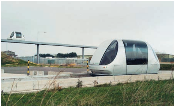
Классика PRT — система ULtra английской компании Advanced Transport Systems Ltd. Уже в этом году 18 таких четырёхместных такси будут возить пассажиров в аэропорту Хитроу
