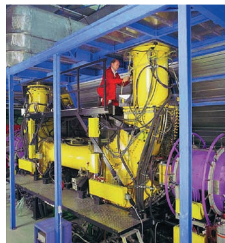
Установка электронного охлаждения на немецком накопительном кольце ESR, построенная учёными из GSI
