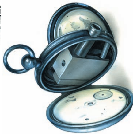
Однозарядные карманные часы в «рабочем» виде и с открытыми крышками. Выстрел производился нажатием на спусковую кнопку под стволом. Западная Европа. Начало XX в.
