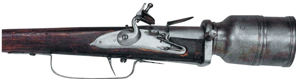
Мортирка ручная трёхфунтовая. Ствол и ударно-спусковой механизм
