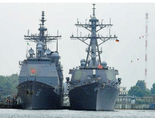
Американские корабли — носители РЛК «Иджис» и УВПУ Mk-41. Слева — крейсер типа «Тикондерога», справа — эсминец типа «Орли Бёрк»
