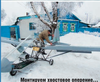
Монтируем хвостовое оперение...
