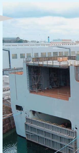
Корабль строился двумя секциями, которые затем соединились в единое целое. На правом фото — уже готовый, состыкованный корпус корабля
