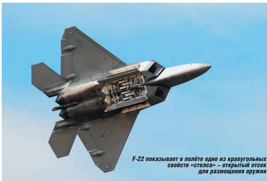
**F-22 показывает в полёте одно из краеугольных свойств «стелса» – открытый отсек для размещения оружия**
