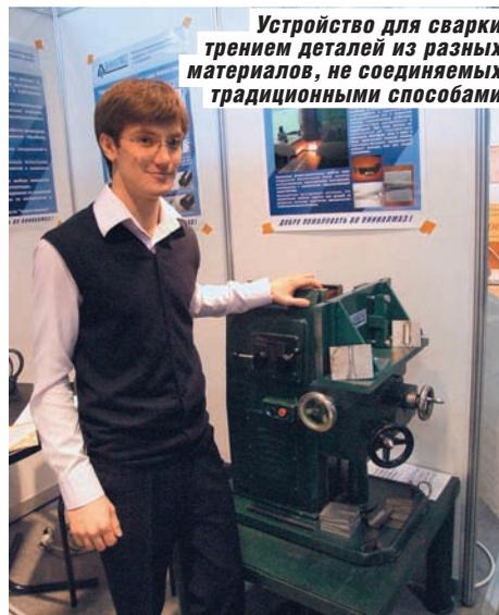
**Устройство для сварки трением деталей из разных материалов, не соединяемых традиционными способами**
