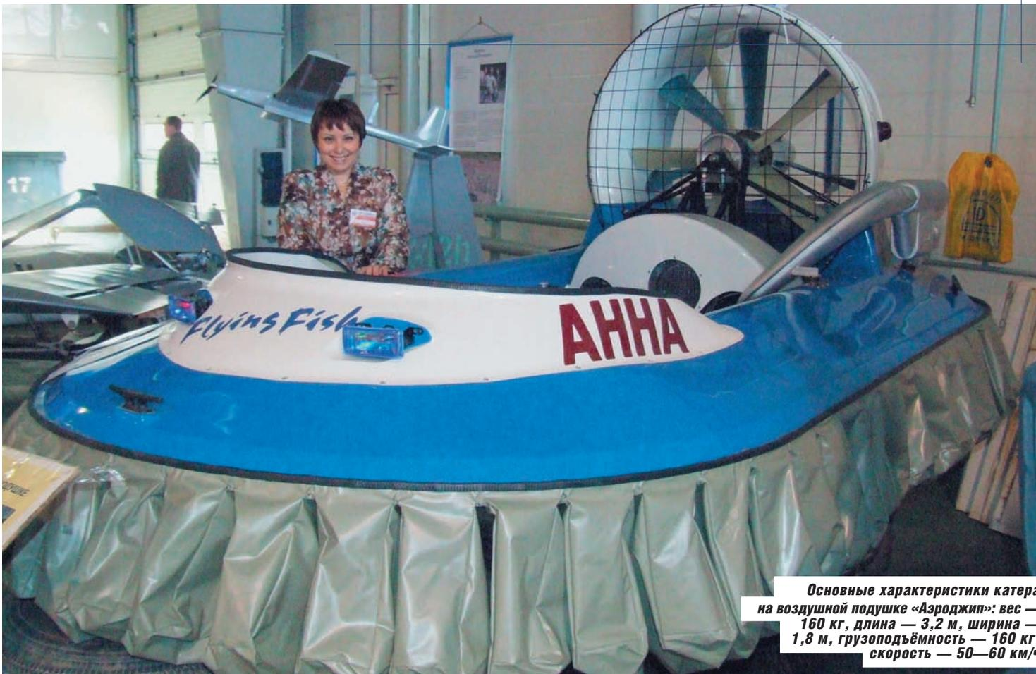
**Основные характеристики катера на воздушной подушке «Аэроджип»:** вес — 160 кг, длина — 3,2 м, ширина — 1,8 м, грузоподъёмность — 160 кг, скорость — 50—60 км/ч
