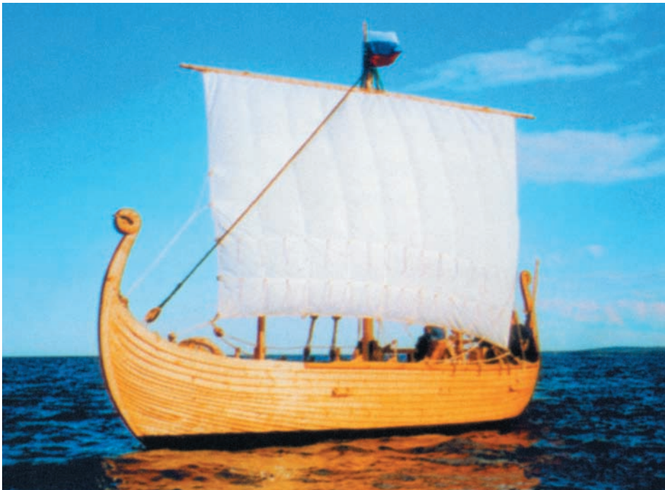
«Аскольд-45/1» — копия ладьи викингов XI в. Водоизмещение — 11 т, длина — 14 м, ширина — 4,1 м, площадь паруса — 48 кв. м, мощность вспомогательного двигателя — 71 л.с.
