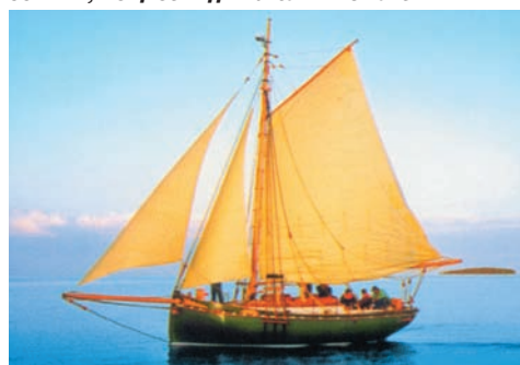
«Грумант-31» — парусно-моторная яхта. Вместимость — 12,4 т, длина — 9,3 м, ширина — 3,4 м, площадь парусов — 66 кв. м, мощность двигателя — 37 л.с.
