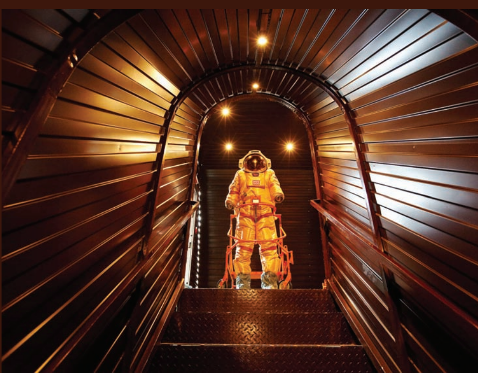
«Марсианский скафандр». Волошин Олег. Скафандр «Орлан-Э» предназначен для выхода на имитируемую марсианскую поверхность в проекте «Марс-500», проводимом ГНЦ РФ-ИМБП РАН под эгидой Роскосмоса и РАН
