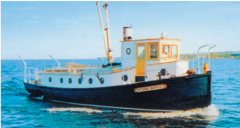
Катер МРБ-40Т — вместимость — 11,5 т, длина — 12,5 м, ширина — 3,1 м, мощность силовой установки — 44 л.с.
