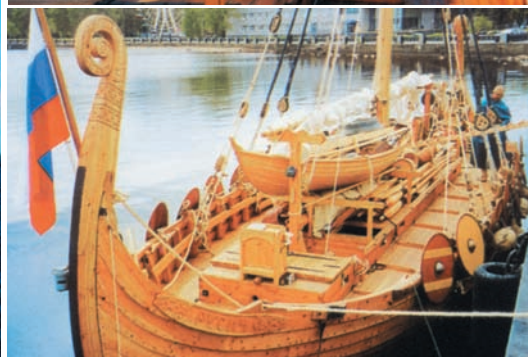
«Аскольд-45/1» — копия ладьи викингов XI в. Водоизмещение — 11 т, длина — 14 м, ширина — 4,1 м, площадь паруса — 48 кв. м, мощность вспомогательного двигателя — 71 л.с.
