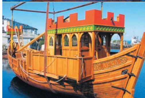
«Аскольд-45/3» — ганзейский когг, торговое судно XIV в. Вместительность — 14 т, длина — 15 м, ширина — 4,2 м, площадь парусов — 48 кв. м, мощность вспомогательного двигателя — 71 л.с.
