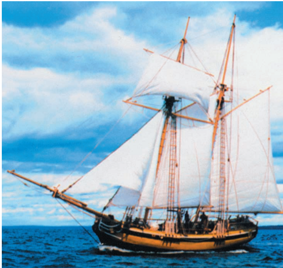
«Груммант-58» — подобие марсельной шхуны XVIII в. Вместимость — 58 т, длина — 17,6 м, ширина — 4,6 м, площадь парусов — 230 кв. м, мощность двигателя — 145 л.с.
